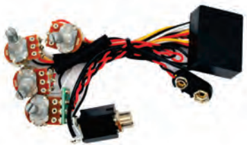
CIRCUITO ATIVO 9010 Cód:CCB 9010-BK 4 Controles Impedância de entrada 20ohm Resposta de frequência 20 Hz 20 kHz Bass 12dB em 85Hz Treble 12dB em 7kHz Split pickup Volume master
