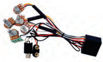
CIRCUITO ATIVO 9060 Cód:CCB 9060-BK 5 Controles Impedância de entrada 20ohm Resposta de frequência 20 Hz 20 kHz Bass 12dB em 85Hz Mid 12dB a 800Hz Treble 12dB em 7kHz Split pickup Volume master
